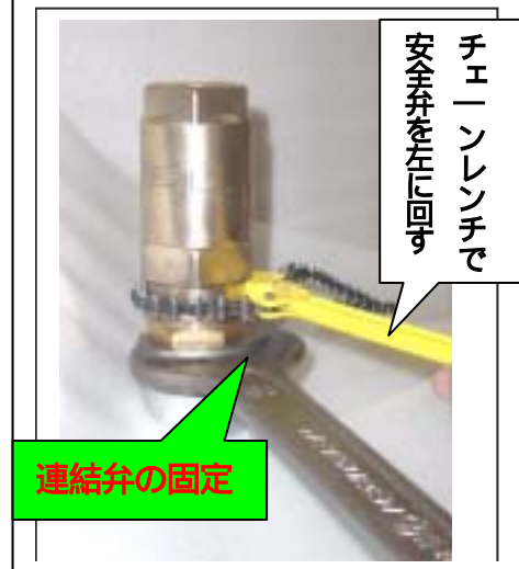
B: 平成 14 年～16 年の安全弁（安全弁工具掛け部は φ55） （エイシン製アルミパイプレンチ EC-510 相当品） （トップ工業製フィルターレンチ TW-230 相当品）
