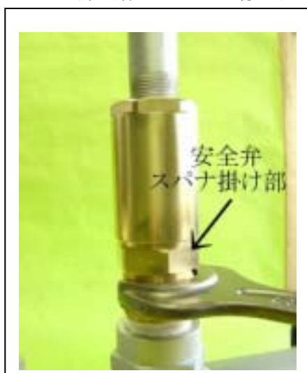
A: 平成14年以前の安全弁（安全弁スパナ掛け部は六角）
